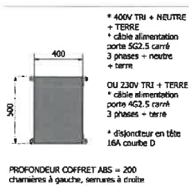
DETAIL B (Echelle : 1/6) perçage fixation au sol
